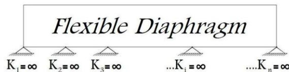
شکل (۲): تیر ارتجاعی بر روی تکیه‌گاه‌های صلب
