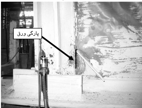
شکل (۱۰): جداشدگی ورق از نبشی در تغییر مکان \delta_{y1} ۳۰/۱۸ در سخت کننده شماره ۲
