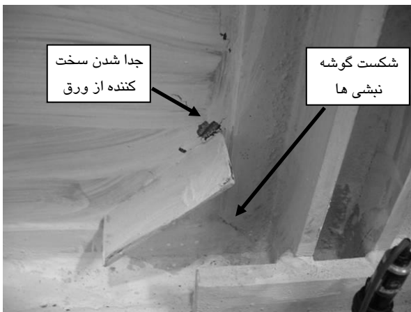
شکل (۷): شکست گوشه های نبشی و جداسازی سخت کننده شماره ۱ از ورق
