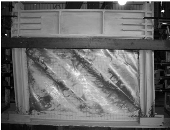
شکل (۱۳): تشکیل پس کمانش در تغییر مکان \delta_{y1} 30/18
