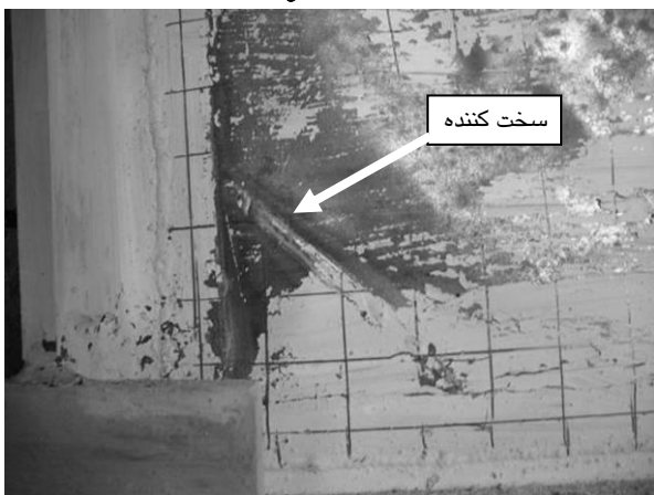
شکل (۱۱): سوراخ شدگی ورق از لبه سخت کننده در تغییر مکان \delta_{y1} ۲۶/۶ در سخت کننده شماره ۱
