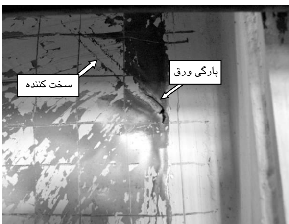
شکل (۸): جداسازی ورق از لبه سخت کننده در تغییر مکان
