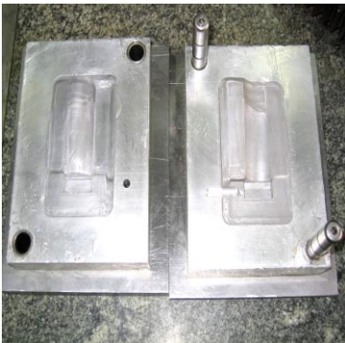
شکل (۷): مراحل گوناگون ساخت قالب اپوکسی (از راست به چپ و از بالا به پایین)
