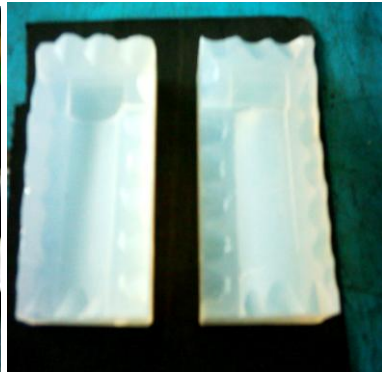
شکل (۸): مراحل گوناگون ساخت قالب RTV (از راست به چپ و از بالا به پایین)
