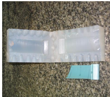
شکل (۹): تولید مدل مومی بوسیله قالب اپوکسی
