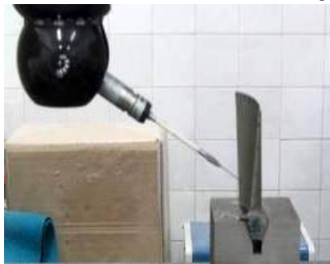
شکل (۱): عملیات داده برداری پره نمونه بوسیله دستگاه CMM
