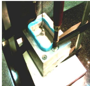
شکل (۷): مراحل گوناگون ساخت قالب اپوکسی (از راست به چپ و از بالا به پایین)
