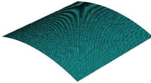
شکل ۱۰. هندسه و نحوه‌ی شبکه‌بندی پوسته‌ی FGM Fig. 10. Geometry and meshing of FGM shell.
