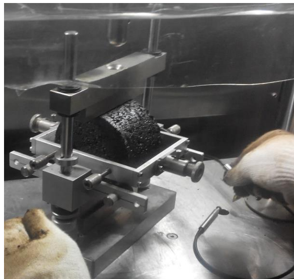
شکل ۵. نحوه قراردادن نمونه در آزمایش Fig. 5. How to place the sample in the experiment
