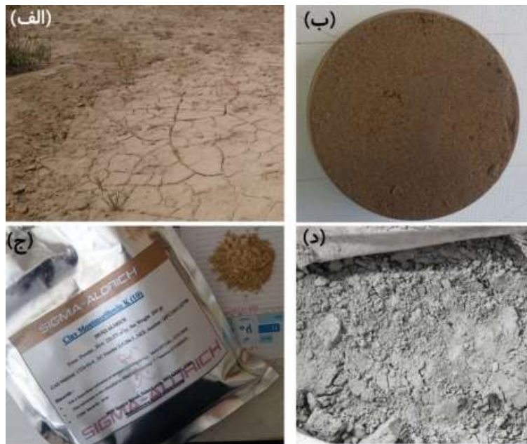
شکل ۵. تصاویری از (الف) خاک فروریزی منطقه سرکوبر سمنان، (ب) نمونه خاک بهسازی شده با نانو رس، (ج) نانو رس ساخت شرکت سیگماآلدریک و (د) سیمان نوع ۲ کارخانه سیمان غرب
