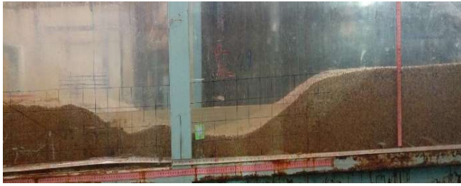
شکل ۶: آبشستگی در بستر محافظت نشده Fig. 6. Scouring in unprotected bed
