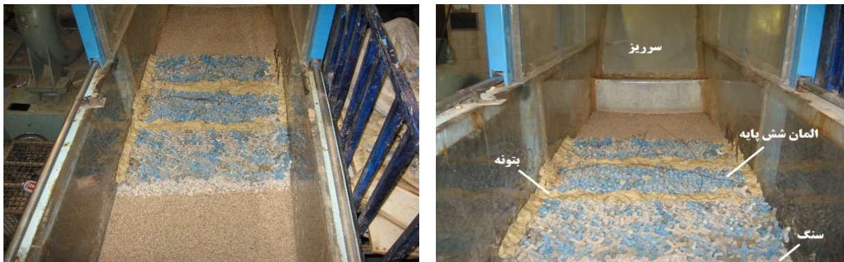
شکل ۷: بستر محافظت شده با A-Jacks و سنگ Fig. 7. Protected bed by A-Jacks and Riprap
