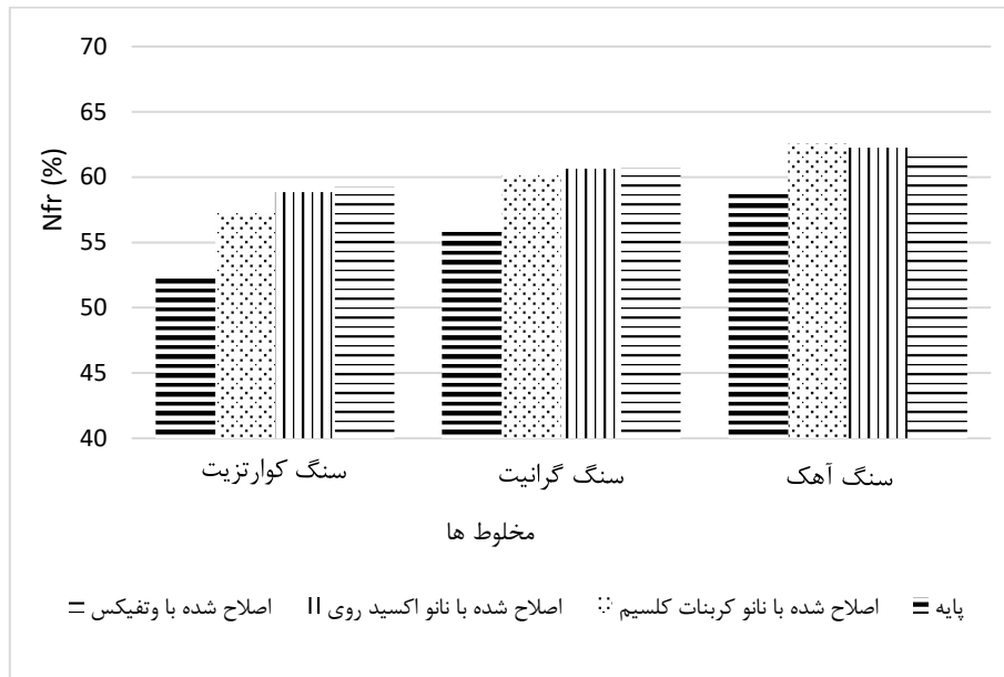
شکل ۳. نسبت عمر خستگی نمونه های ساخته شده با قیر ۶۰-۷۰ Fig. 3. Fatigue life ratio of samples made with AC 60-70
