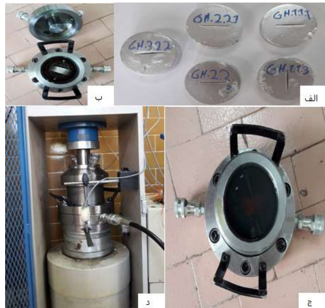
شکل ۸. (الف) رنگ کردن نمونه‌ها توسط اسپری جهت جلوگیری از نفوذ روغن به داخل نمونه، (ب) قرار دادن نمونه در داخل سلول، (ج) پر کردن سلول توسط روغن جهت ایجاد فشار محصور کننده و (د) قرار دادن سلول در محفظه دستگاه بارگذاری تک محوری
