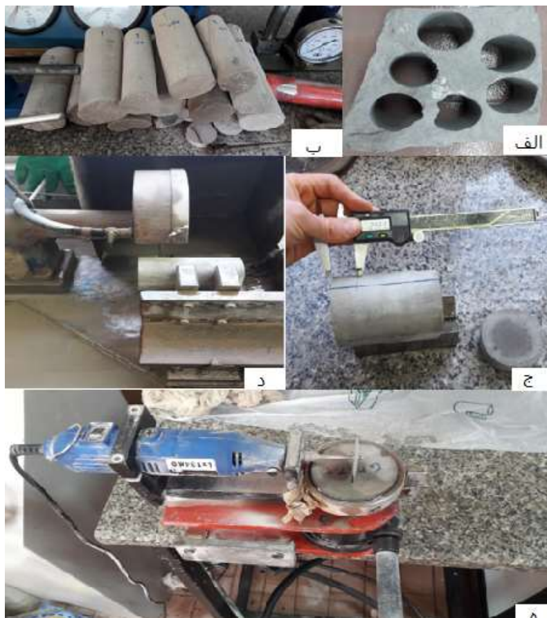
شکل ۶. (الف) مغزه‌گیری از بلوک سنگی، (ب) مغزه‌های بدست آمده از بلوک‌های ماسه‌سنگ، (ج) علامت زدن مغزه‌ها در ضخامت معین توسط کولیس، (د) برش مغزه به ضخامت مورد نظر توسط دستگاه برش و (ه) فرز انگشتی جهت ایجاد شکاف چورون
