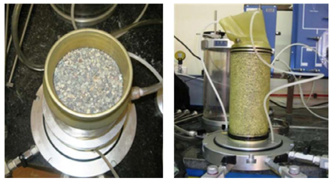
شکل ۵. آماده‌سازی نمونه دانه‌ای برای آزمایش سه محوری Fig. 5. Preparation of stone columns material for Triaxial test
