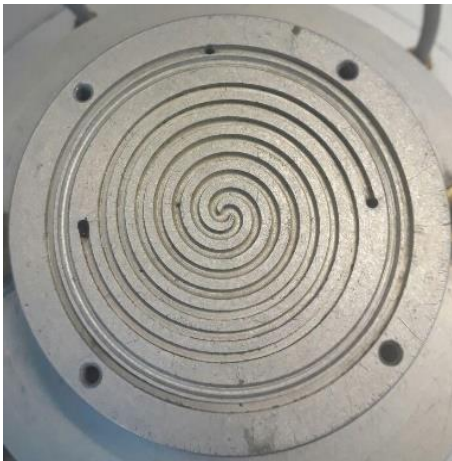
(ب): صفحه پایه حلزونی (b) Grooved base plate
