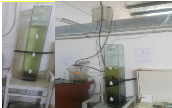
شکل ۳. نمای راکتورهای UASB مورد استفاده در تحقیق حاضر Fig. 3. View of the UASB reactors used in the present study
