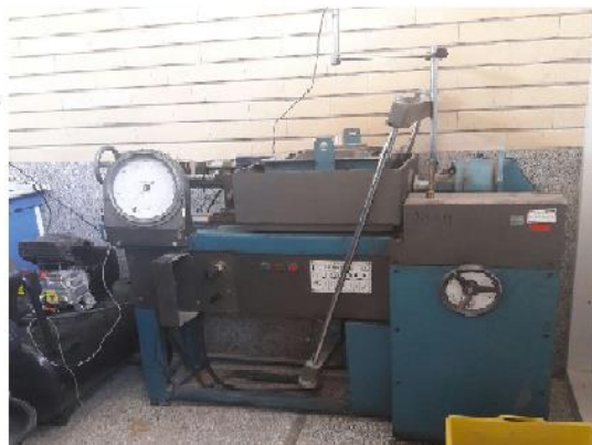
شکل ۳. دستگاه برش مستقیم و دیتالاگر ۸ کاناله
