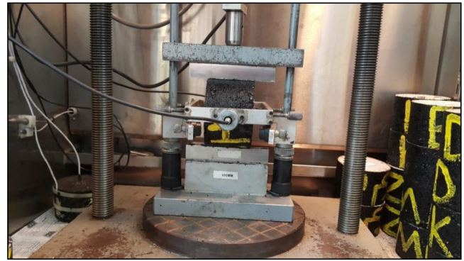
شکل ۲. تصویری از نحوه قرارگیری نمونه در آزمایش مدول برجهندگی Fig. 2. A picture of how to place a specimen in the resilient modulus test
