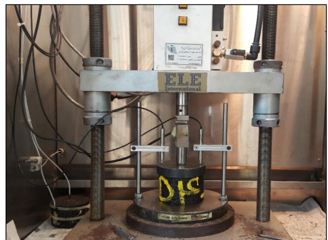
شکل ۳. تصویری از نحوه قرارگیری نمونه در آزمایش خزش دینامیکی Fig. 3. A picture of how to place a specimen in the dynamic creep test
