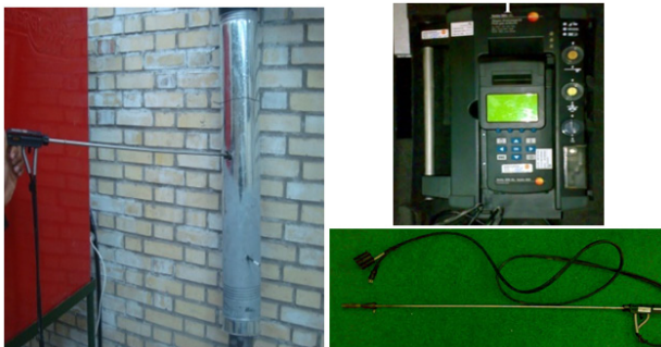
شکل ۷: نمونه گیری از گازهای خروجی دودکش و دستگاه آنالیز گاز
