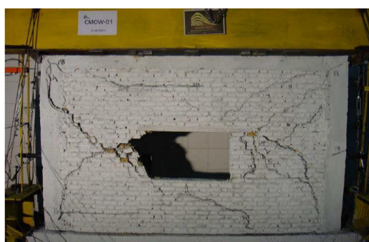
شکل ۶. تصویر نمونه دارای کلاف پس از اتمام آزمایش [۶]
