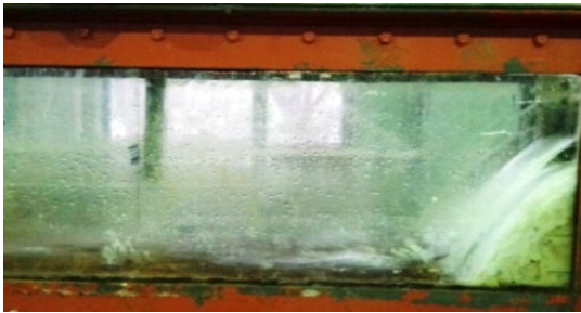
ب: نمایی از سرریز اوجی با شیب وجه بالادست 45 درجه
