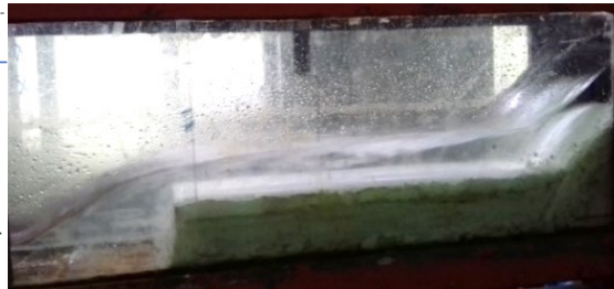
ج: نمایی از سرریز اوجی با کفبند به ارتفاع 10 سانتی متر در پایین دست
