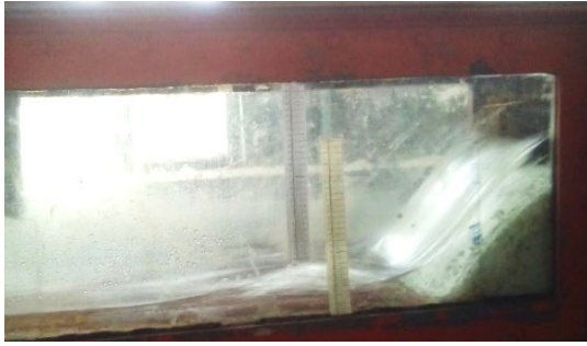
الف: نمایی از سرریز اوجی با وجه بالادست قائم
