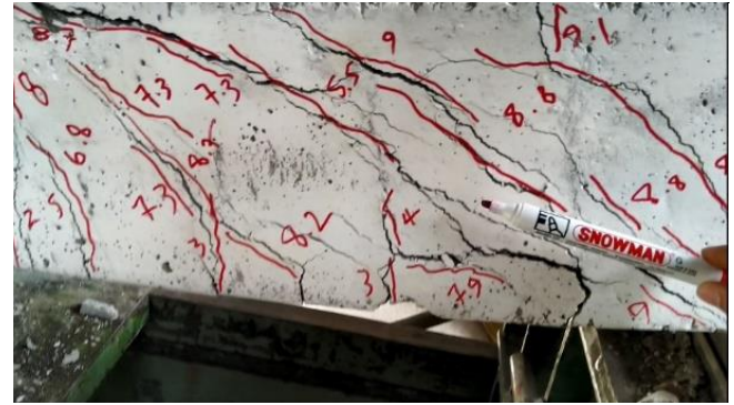
شکل ۲۶. ترک های ایجاد شده در نمونه بدون الیاف و با خوردگی سطح دو (NC-C2)
