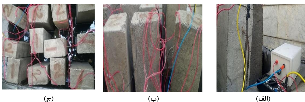
شکل ۶. نمایی از نمونه های آزمایشگاهی در استخر نمک برای اعمال خوردگی تسریع شده الف) منبع تغذیه و آمپرسنج برای نمایش میزان خوردگی ب) نمایی از مدار الکتریکی برای ایجاد خوردگی تسریع شده ج) نمایی از تیرها در آزمایش خوردگی
