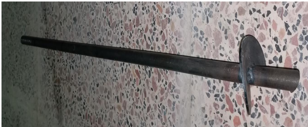
شکل ۶. شمع پیچشی با گام ۲ سانتی‌متر Fig. 6. The helical pile with a pitch of 2 cm
