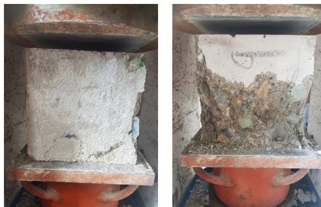
شکل ۵. مقایسه حالت شکست تحت بارگذاری فشاری: تصویر سمت راست نمونه بدون الیاف پت و تصویر سمت چپ نمونه حاوی ذرات پت Fig. 5. Comparison of failure mode under compressive loading
