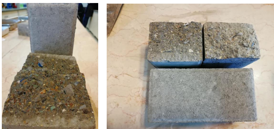
شکل ۶. نمونه‌های شکسته شده روسازی بتنی حاوی پت
