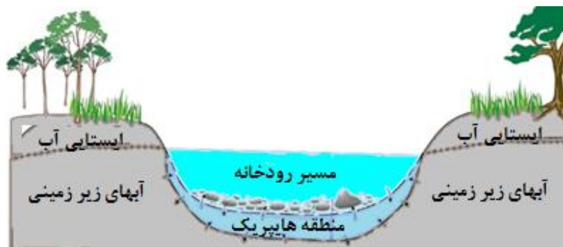
شکل ۱. تبادل جریان بین آب سطحی و زیرسطحی منطقه هایپریک [۱]
