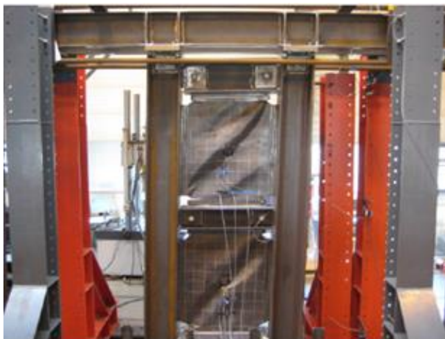
شکل ۳. گسترش ترک در ورق فولادی [۸] Fig. 3. Crack propagation in infill plate [8]
