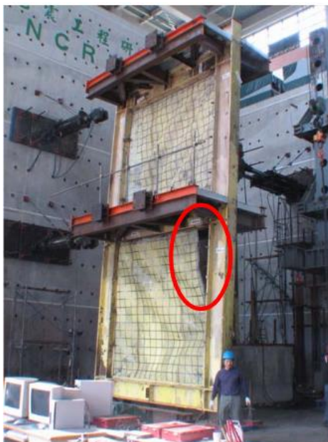
شکل ۲. گسترش ترک در مدل آزمایشگاهی دیوار برشی فولادی دو طبقه [۷]
