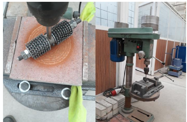
شکل ۲. دستگاه سایش و نحوه‌ی کار آن Fig. 2. Abrasion resistance test machine
