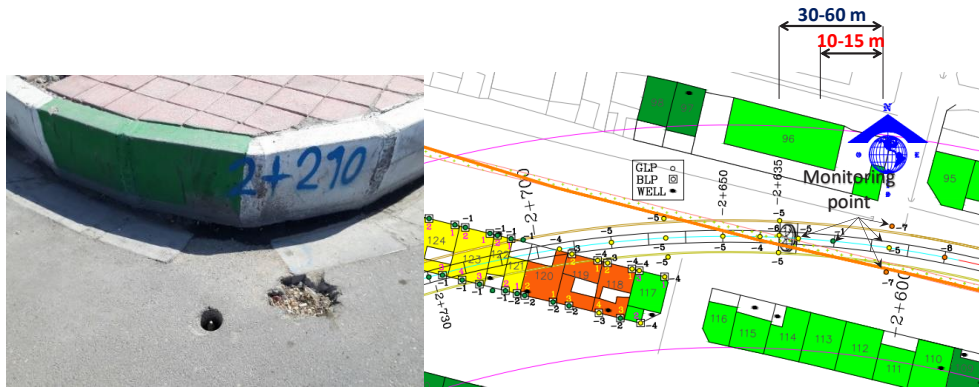
شکل ۹. نقاط نشست‌سنجی سطحی زمین در امتداد محور تونل Fig. 9. Surface settlement monitoring points along the tunnel axis
