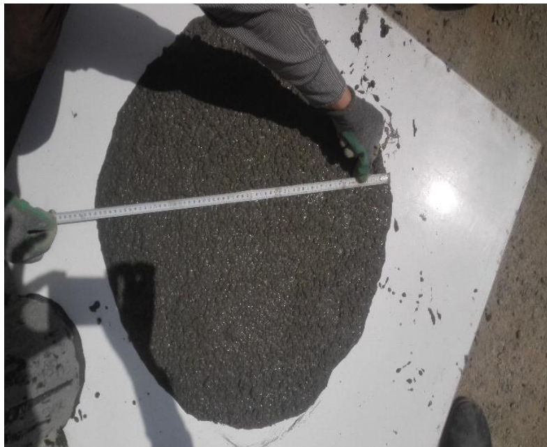
شکل ۴. اسلامپ بتن حاوی ۱٪ الیاف بازالت
