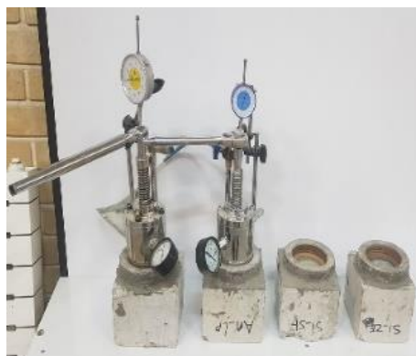
(الف) نمونه‌های بتنی آماده شده برای آزمایش "محفظه استوانه‌ای"
