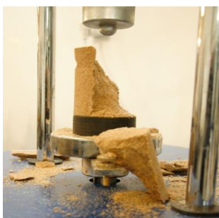
شکل ۴. نمونه شکسته شده پس از آزمون تک محوری Fig. 4. Broken uniaxial specimen
