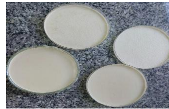
شکل ۱۱. رسوبات ته‌نشین شده جهت ارائه نمونه آزمون XRD Fig. 11. Deposited sediments to present the XRD test sample
