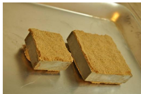
شکل ۶. نمونه دست نخورده آماده شده در قالب و آماده انتقال به قالب اصلی دستگاه برش مستقیم
