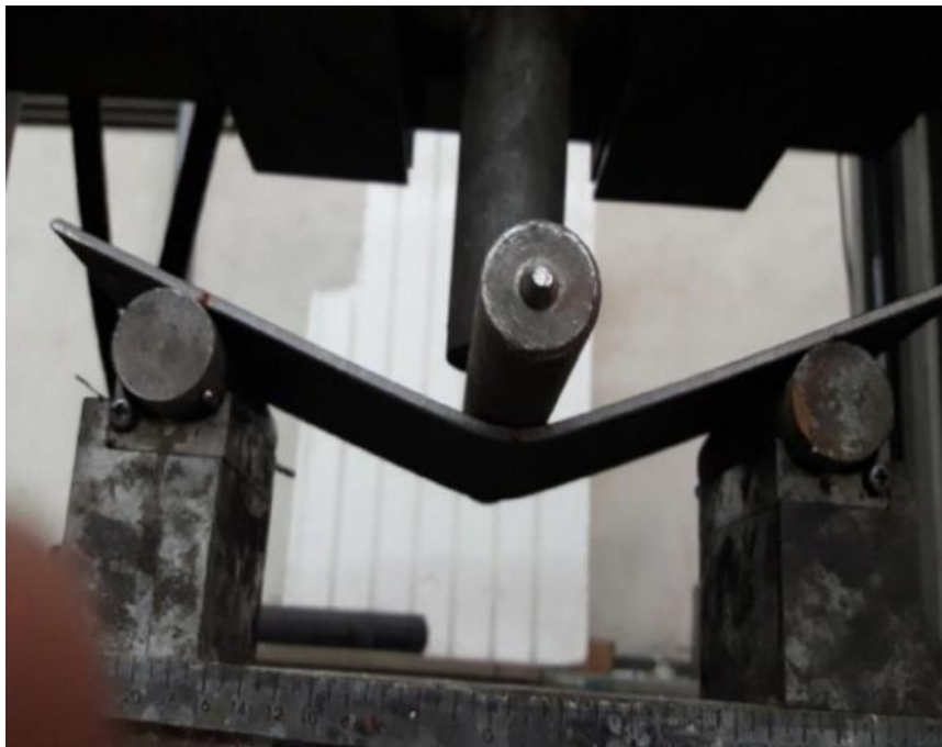
شکل ۱۴. نمونه SB-۲ - تحت آزمایش خمش - بعد از بارگذاری
