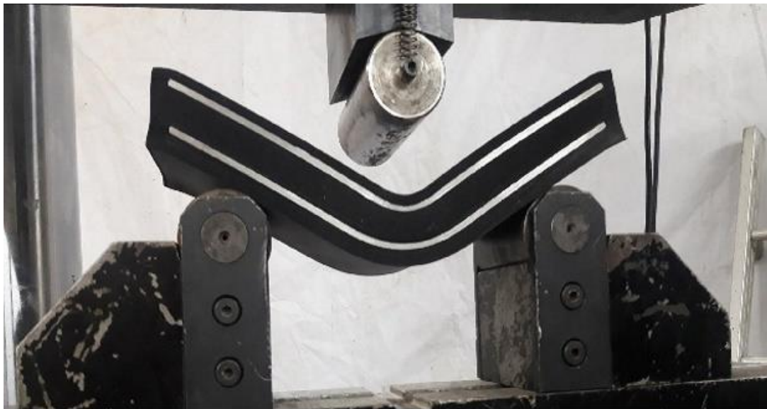
شکل ۲۶. نمونه ساندویچی پس از برداشتن بار.
