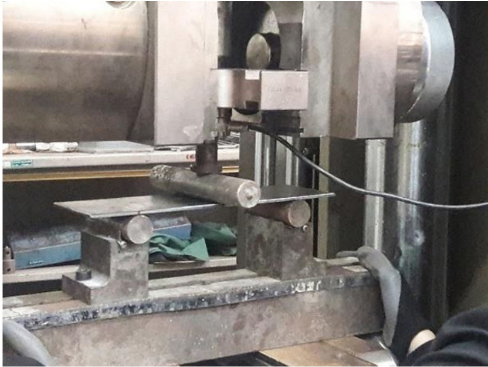
شکل ۱۳. نمونه SB-۲ - تحت آزمایش خمش - قبل از بارگذاری
