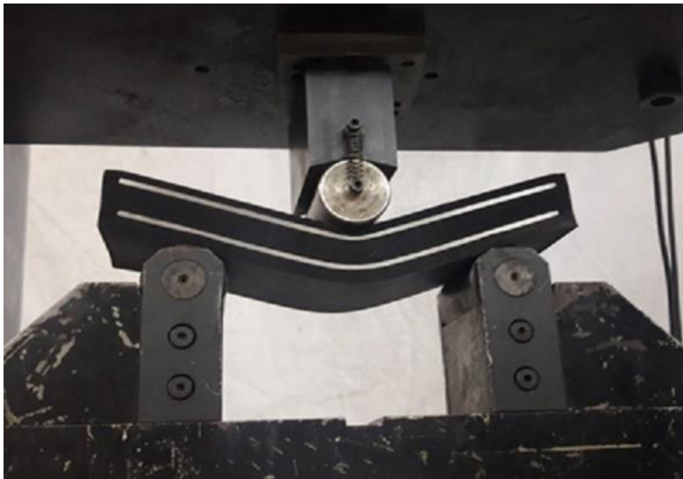
شکل ۲۴. نمونه ساندویچ در حین بارگذاری
