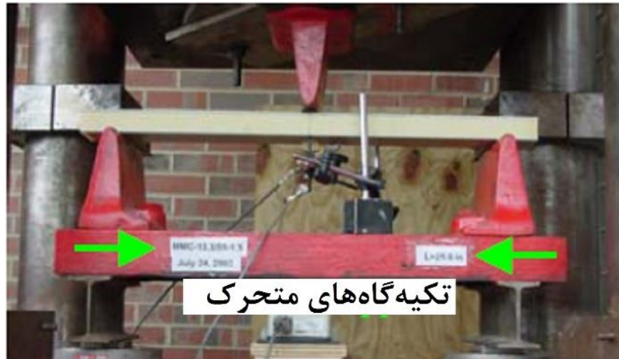
شکل ۲. آزمایش خمشی سه‌نقطه بر ساندویچ پانل FRP [۱۱].
