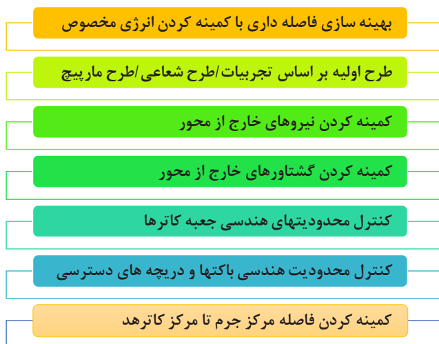
شکل ۱۲. مراحل کلی بررسی تعادل استاتیکی کاترهد
