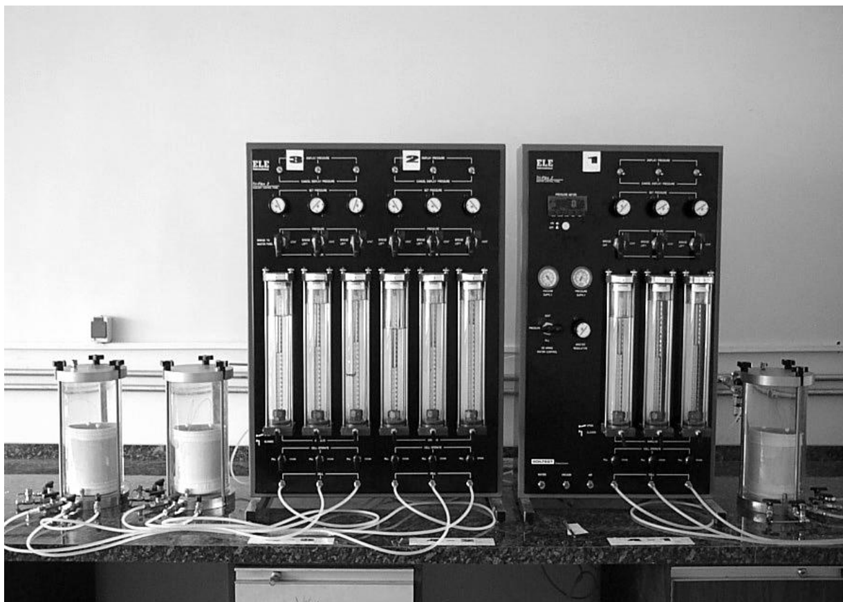
شکل ۳. دستگاه نفوذپذیری سه محوری با دیواره انعطاف پذیر
