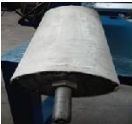
شکل ۲. قالب بیضی ساخت ستون‌ها
