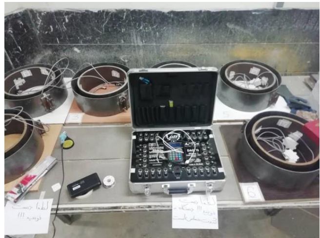
شکل ۳. قالب‌های ساخته شده برای آزمایش جمع شدگی مقید پیش از قالب‌گیری بتن (سمت راست) و در هنگام داده برداری (سمت چپ)
