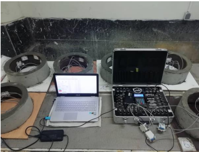
شکل ۳. قالب‌های ساخته شده برای آزمایش جمع شدگی مقید پیش از قالب‌گیری بتن (سمت راست) و در هنگام داده برداری (سمت چپ)
