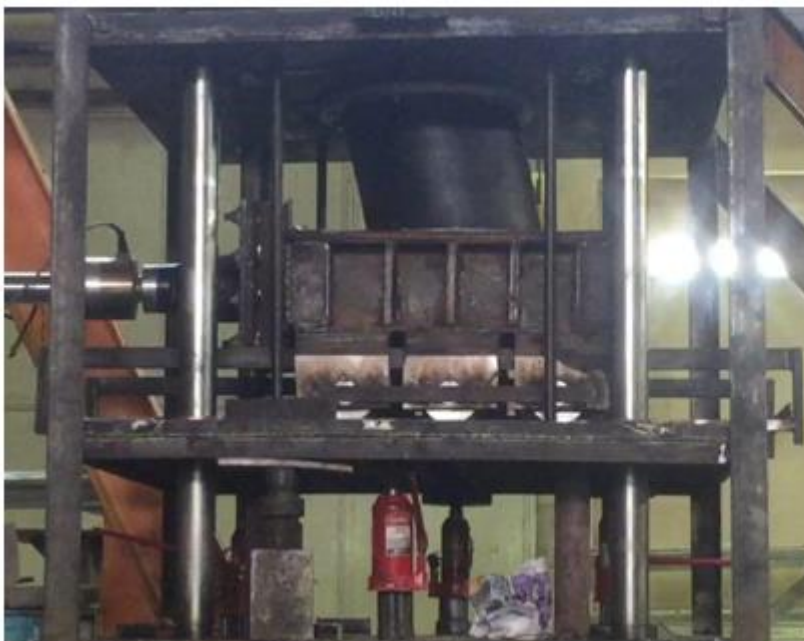
شکل ۱۰. جداگر الاستومری در مطالعات حکیمیان- تقی خانی به همراه مدل آزمایشگاهی و اجزای محدود آن [۴]
