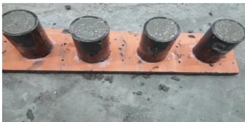
شکل ۲. نمونه‌های استوانه‌ای پر شده از بتن جهت تعیین خصوصیات فیزیکی و مکانیکی بتن
