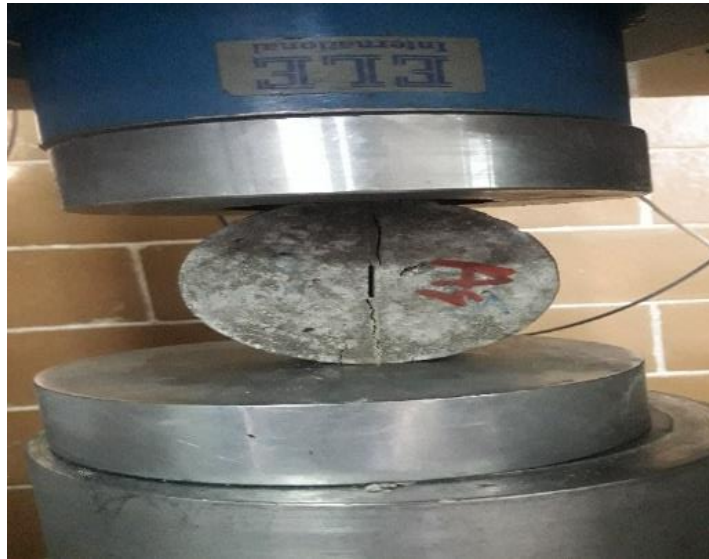
شکل ۱۳. نمونه بتنی در هنگام آزمایش
