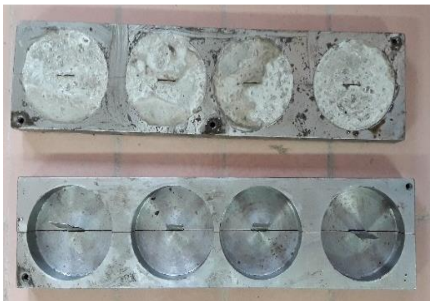
شکل ۳. قالب پر شده از بتن جهت تهیه دیسک برزیلی با ترک مستقیم
