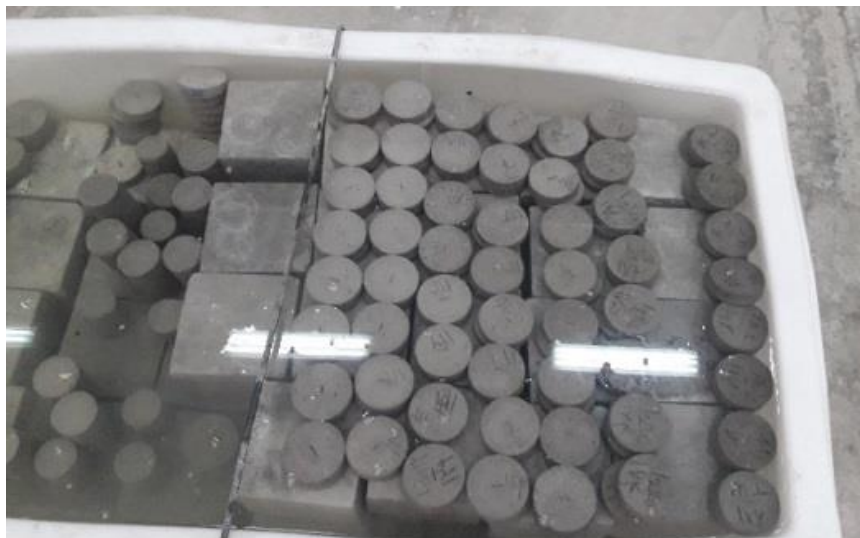
شکل ۵. وان‌های آب آهک جهت عمل‌آوری نمونه‌های بتنی
