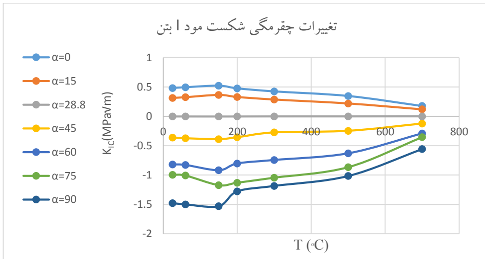
شکل ۱۰. اثر درجه حرارت بر روی چقرمگی شکست مود I
