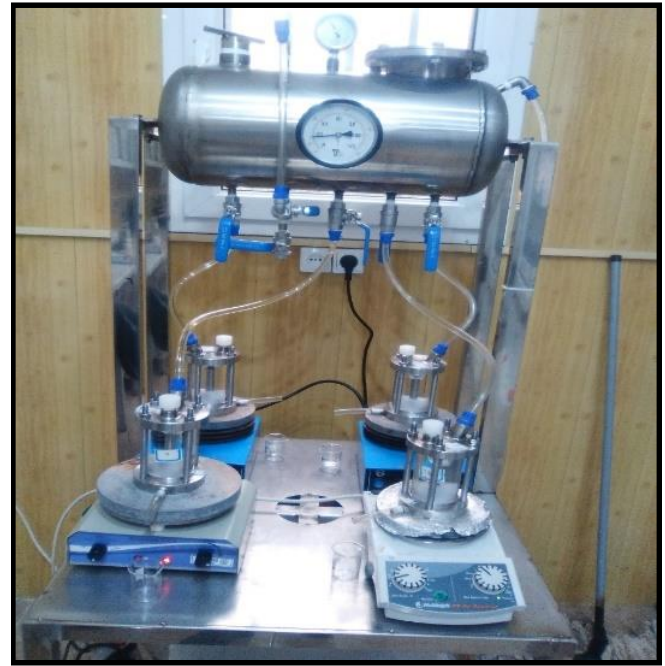
شکل ۱. نمونه‌های تحت آزمایش در دستگاه نانوفیلتراسیون غشایی
