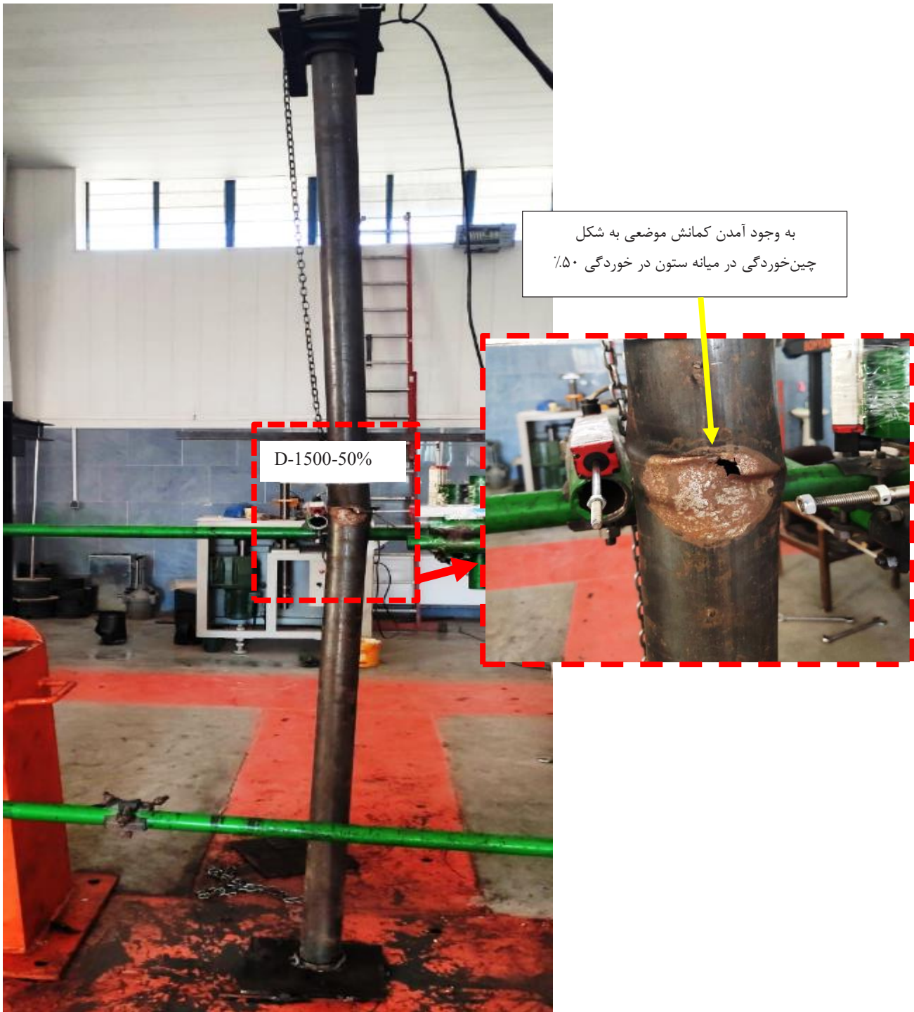
شکل ۱۶. حالت کمانش ستون با خوردگی ۵۰٪ در میانه انجام شده به صورت آزمایشگاهی
