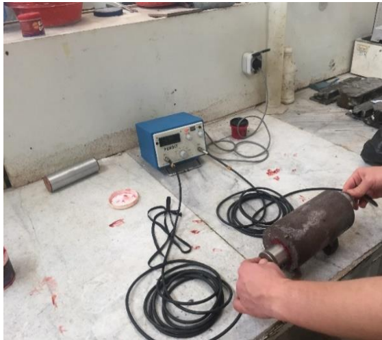
شکل ۱۴. آزمایش سرعت موج فراصوت نمونه بتنی
