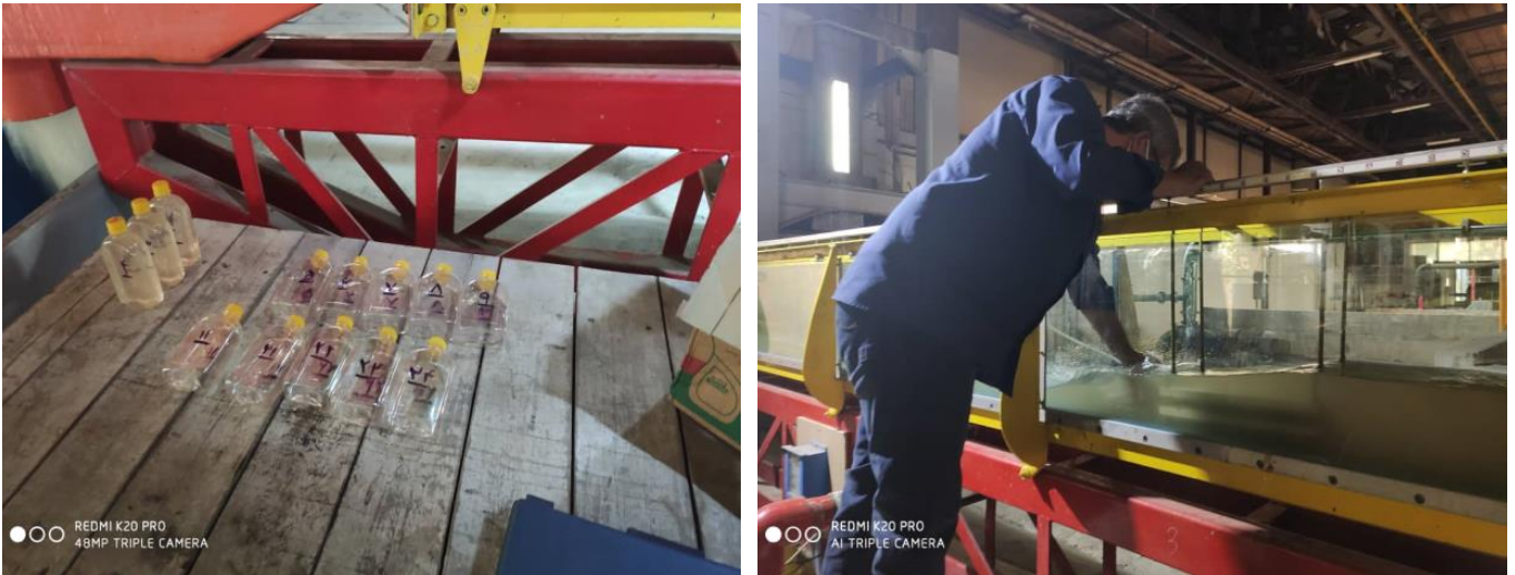
شکل ۴. نمونه گیری جهت بررسی غلظت جریان رسوبی با روش TSS
