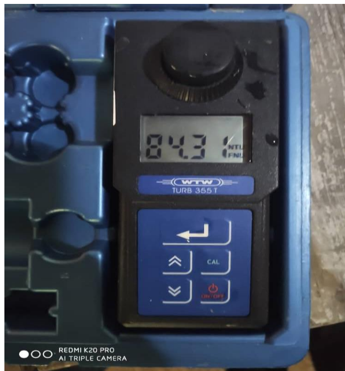
شکل ۵. کدورت سنج مرجع مدل Turb @ T ۳۵۵
