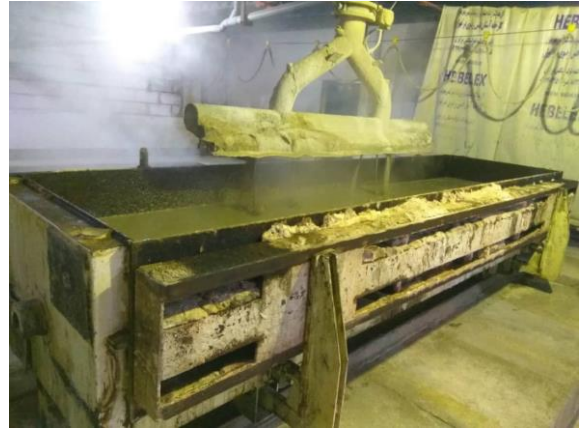
الف) ریختن دوغاب بلوک به داخل قالب
