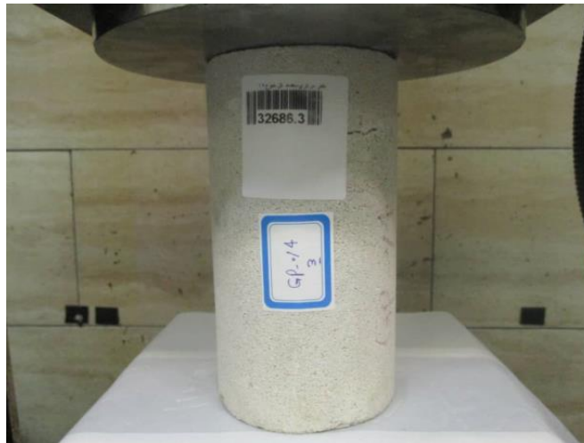
شکل ۵. آزمایش مقاومت فشاری نمونه‌ها
