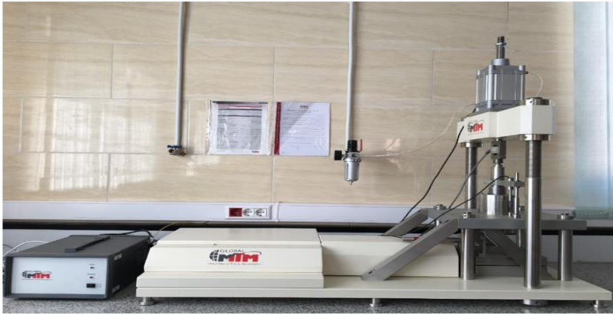
شکل ۱. نمای کلی از دستگاه برش ساده استفاده شده
