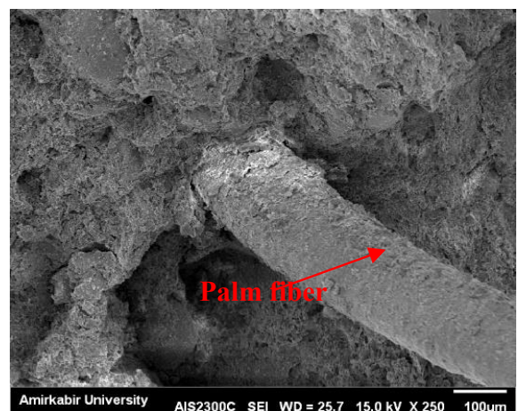
شکل ۸. تصویر میکروسکوپ الکترونی از الیاف درون خشت
