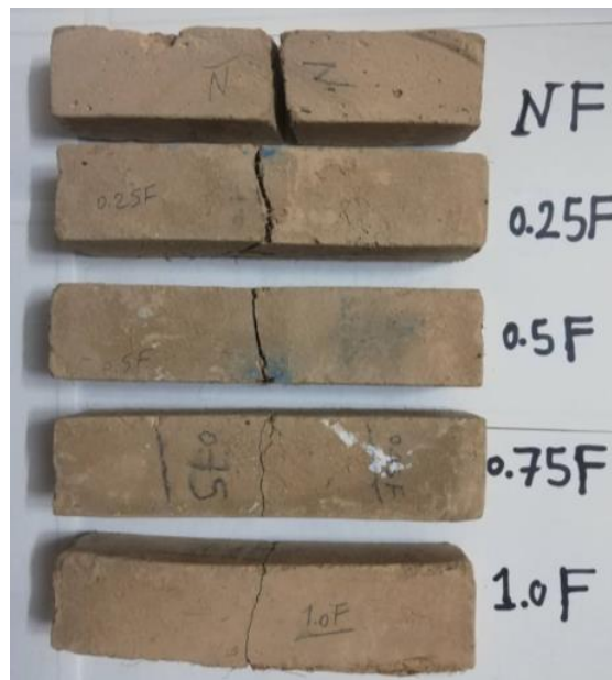
شکل ۱۴. نمونه‌ها بعد از آزمایش خمش سه نقطه‌ای
