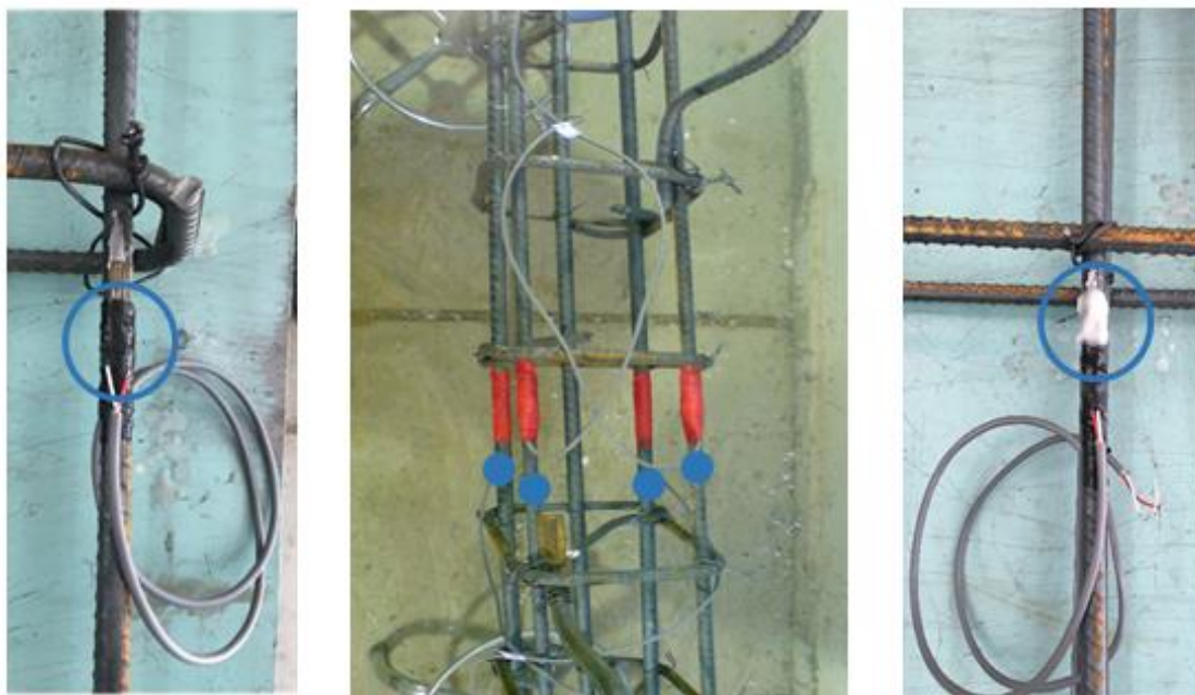
شکل ۵. نحوه اتصال و عایق‌بندی کرنش‌سنج‌ها بر روی میلگرد.
