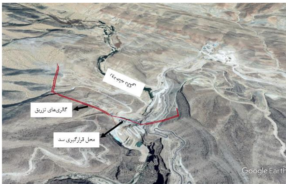
شکل ۱. موقعیت رودخانه دالکی، جاده فیروزآباد - هنگام و گالری‌های تزریق نسبت به سد هایقر
