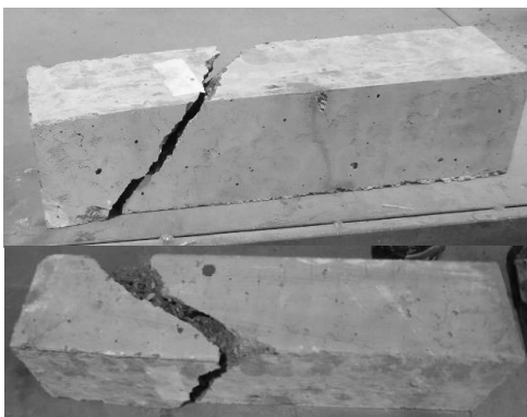
شکل (۳): نمونه‌های شکسته شده در آزمایش مقاومت پیچشی بتن
