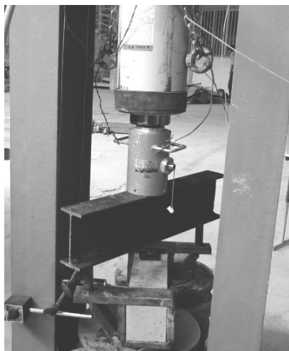
شکل (۲): دستگاه ساخته شده توسط مولف برای انجام آزمایش مقاومت پیچشی بتن
