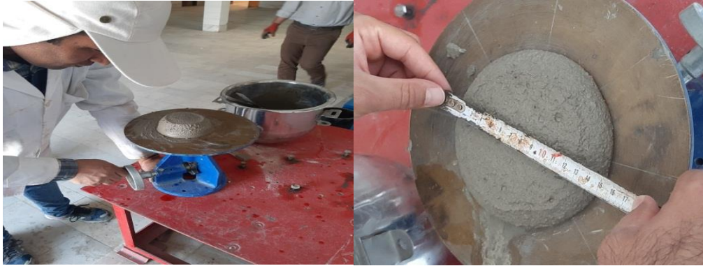
شکل ۴. نحوه انجام آزمایش میز جریان
