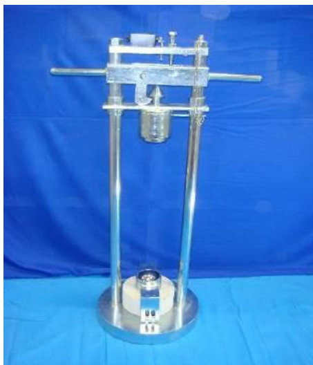
شکل ۱۸. نمای شماتیک و گرافیکی دستگاه تست ضربه افتان
