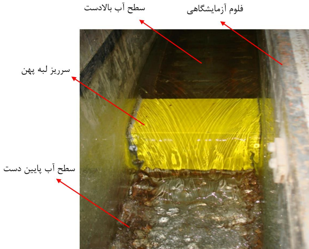
شکل ۲-ج. جریان از روی سرریز لبه پهن مستطیلی [۲۸]
