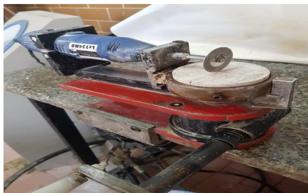
شکل ۵. دستگاه فرز انگشتی برای ایجاد ترک چورون
