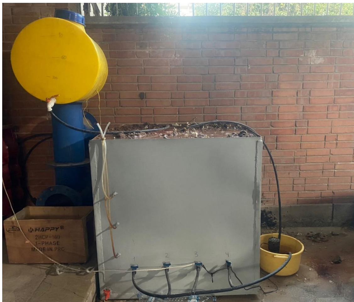
شکل ۱۱. سیستم نیمه صنعتی طراحی شده برای آزمایش فیلتر زهکش جهت حذف نیترات
