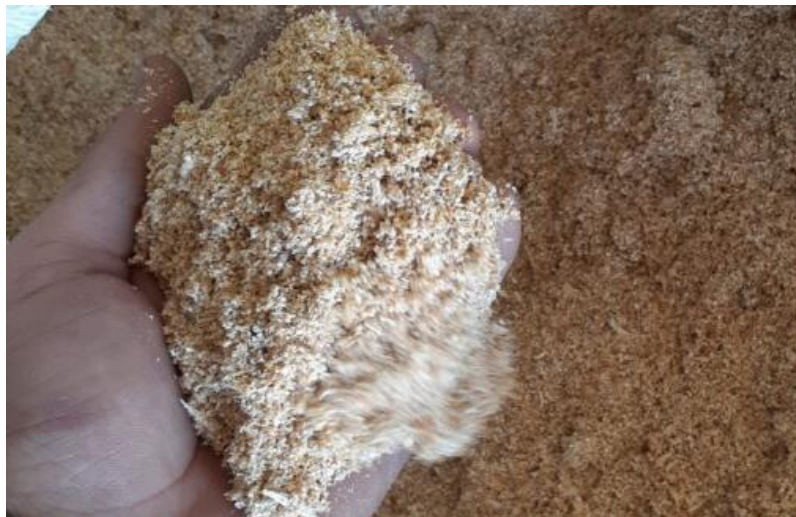
شکل ۵. خاک اره مصرفی در فیلتر زهکش
