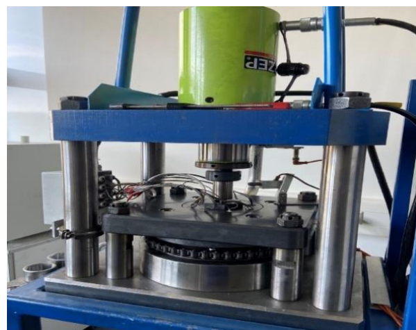
شکل ۲. دستگاه فرآیند اکستروژن پیچشی فشار بالا در مؤسسه فناوری کارلسروهه ۱
