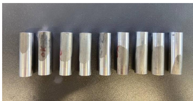
شکل ۱. نمونه‌های آماده شده جهت فرآیند اکستروژن پیچشی فشار بالا
